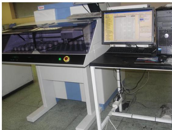
**Figura A-7** Espectrômetro de fluorescência de raio-X
