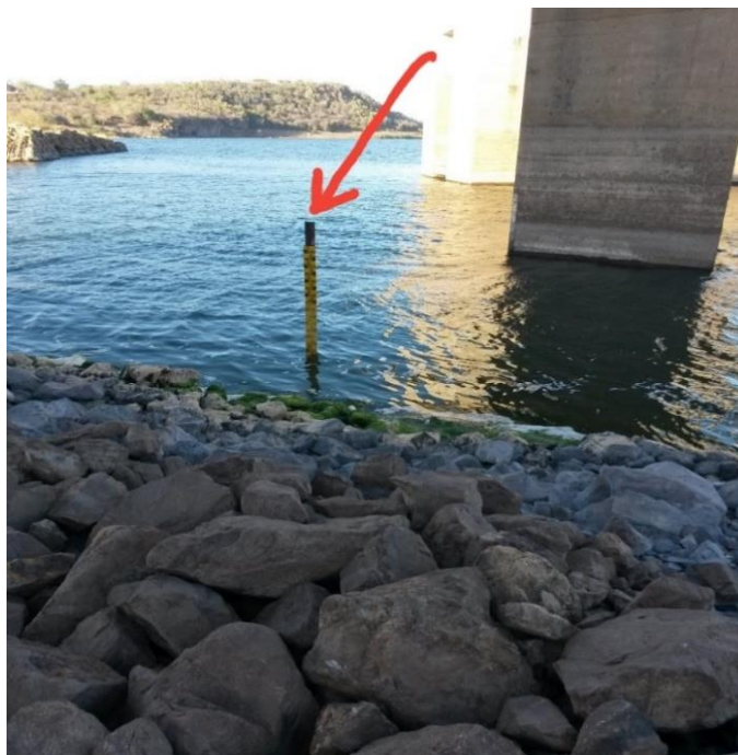
Figura 4.2: Escala hidrométrica através da qual se realiza a leitura da cota
