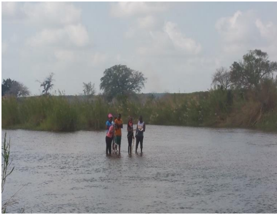
Figura 4.3: Medição de caudal líquido na estação de Magude
