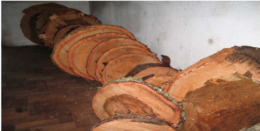
Figura 3 — Fatias de Pinus taeda L. in natura acondicionadas para secagem
