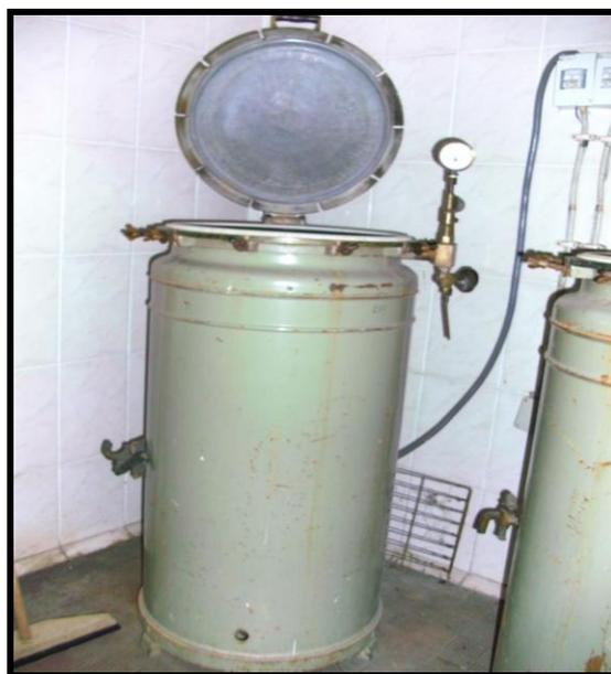
**Figura XVIII.** Figura da autoclave vertical usada no estudo (H.E.V., 2010).
