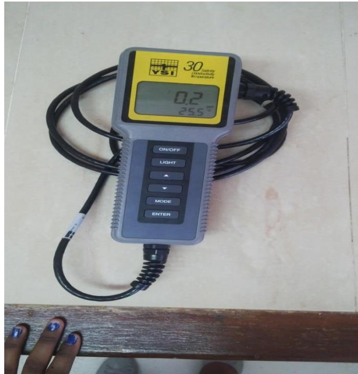
**Figura 5.** Salinómetro YSI30
