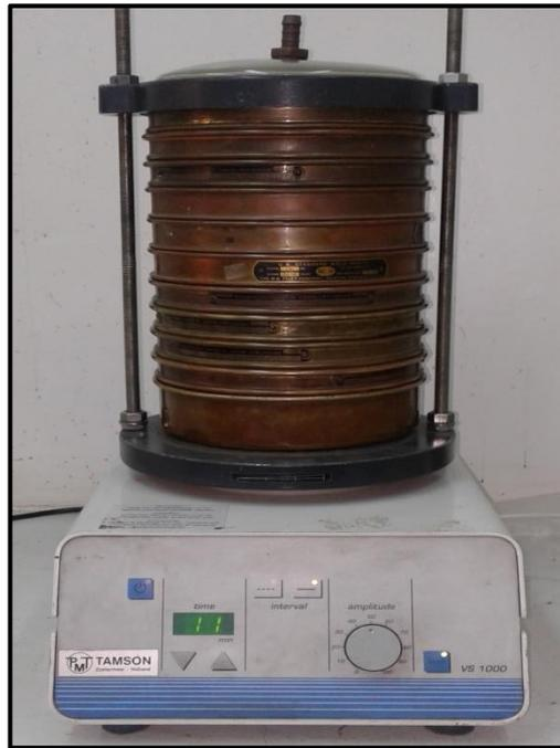
**Figura 7:** Peneiramento de sedimentos pelo vibrador.
