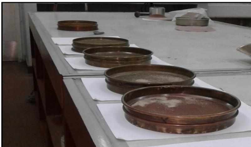
**Figura 8:** Remoção dos sedimentos da peneira para a pesagem.
