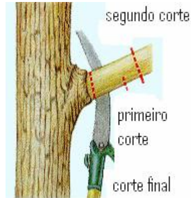
Figura 2: Ilustração da poda em três cortes usando serra manual
