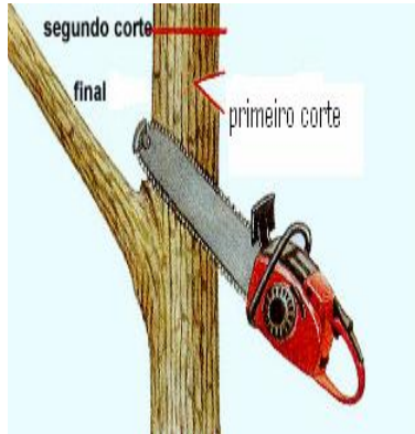
Figura 1: Ilustração da poda em três cortes usando motosserra
