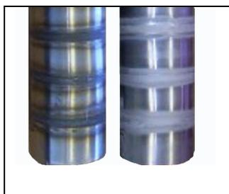
Fig. 1; Peças de aço mostrando o "antes" e "depois" da decapagem ácida
