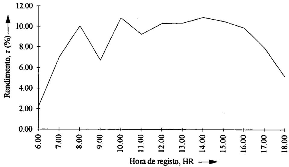
Fig.20. Curva de rendimento do painel num dia frio (céu nublado,  $T_a=17.98$  °C e  $T_p=20.23$  °C)
