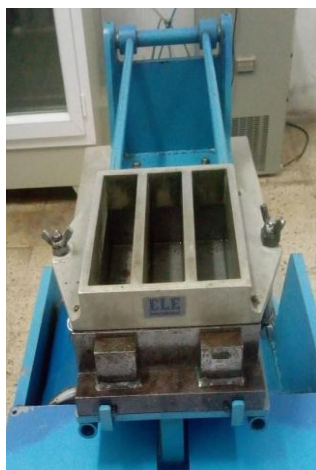
Figura 12- Molde e prolonga fixados no compactador.
