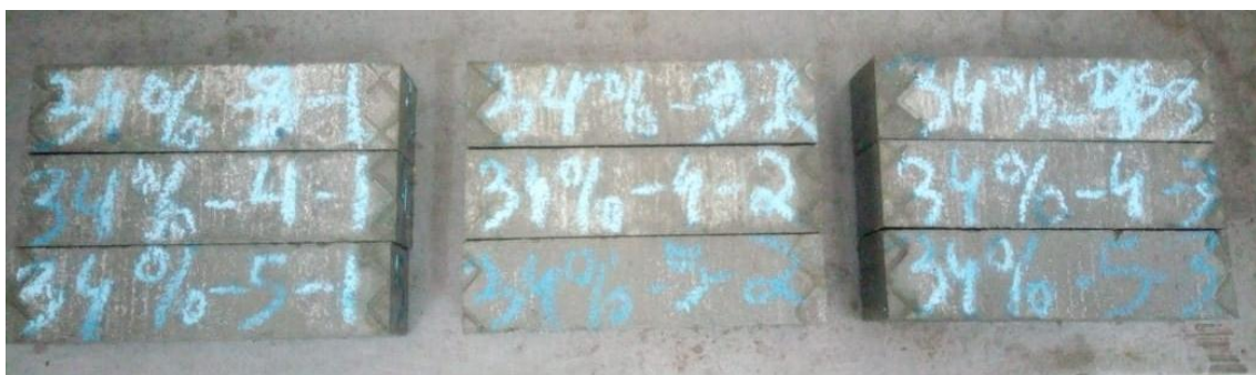
Figura 15- Provetes desmoldados e após 24h de cura devidamente identificados.
