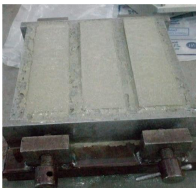
Figura 13- Molde prismáticos contendo argamassa após a compactação.
