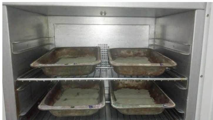
Figura 20- Tabuleiros contendo amostra de cimento na estufa para secagem com ventilação.
