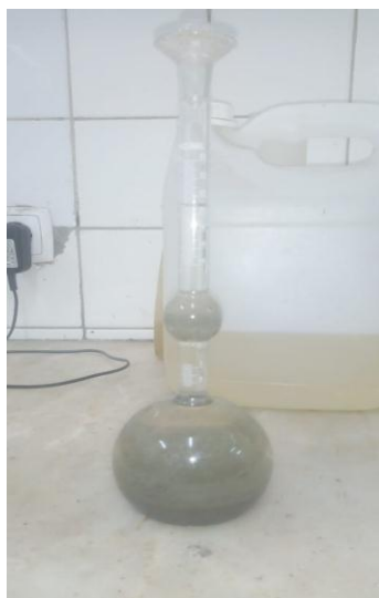
Figura 21 -Frasco volumétrico de Le Chatelier contendo petróleo e 65g de cimento.
