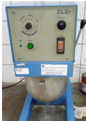
Figura 11- Misturadora de argamassa e pasta de cimento.
