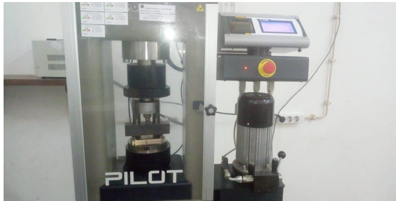
Figura 17- Prensa hidráulica para ensaio de resistência à flexão e resistência à compressão.
