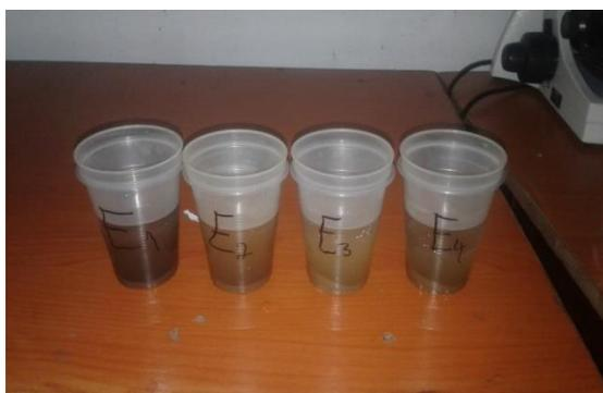
**Figura 10.** Ataque dos carbonatos nos sedimentos a partir do ácido clorídrico.
