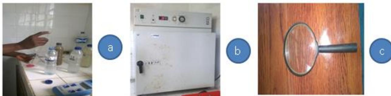
**Figura 13.** A figura ilustra: a) colocação das gotas de água na membrana petrifilm; b) estufa e c) lupa.
