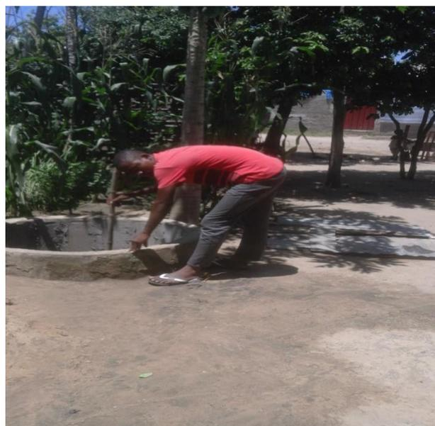
**Figura 19.** Medição do nível da água com auxílio de uma estaca graduada.
