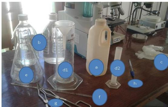
**Figura 9.** Material usado no laboratório: a) ácido clorídrico; b) água destilada; c) luvas; d1e2) provetas graduadas; e) balão volumétrica; f) pipeta; g) ganchos e h) esferográfica.
