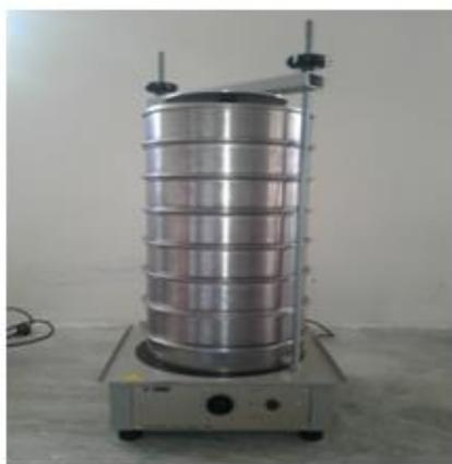
**Figura 11.** Agitador mecânico.
