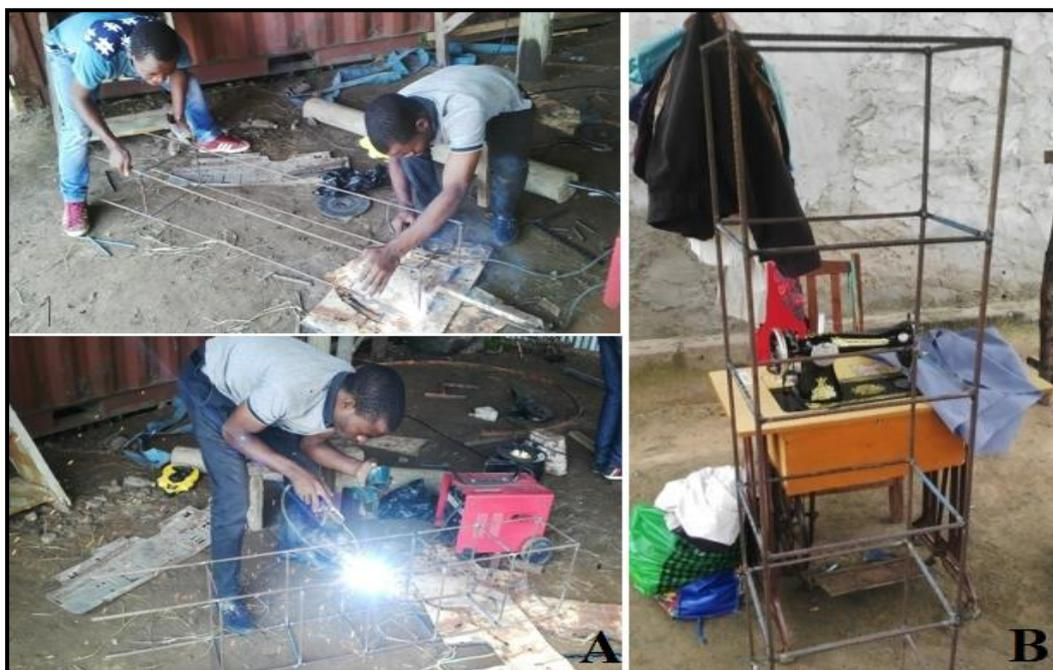
**Figura 15:** A) Soldadura da armadilha e B) Retirada das medidas para a costura dos tecidos da cobertura da armadilha.
