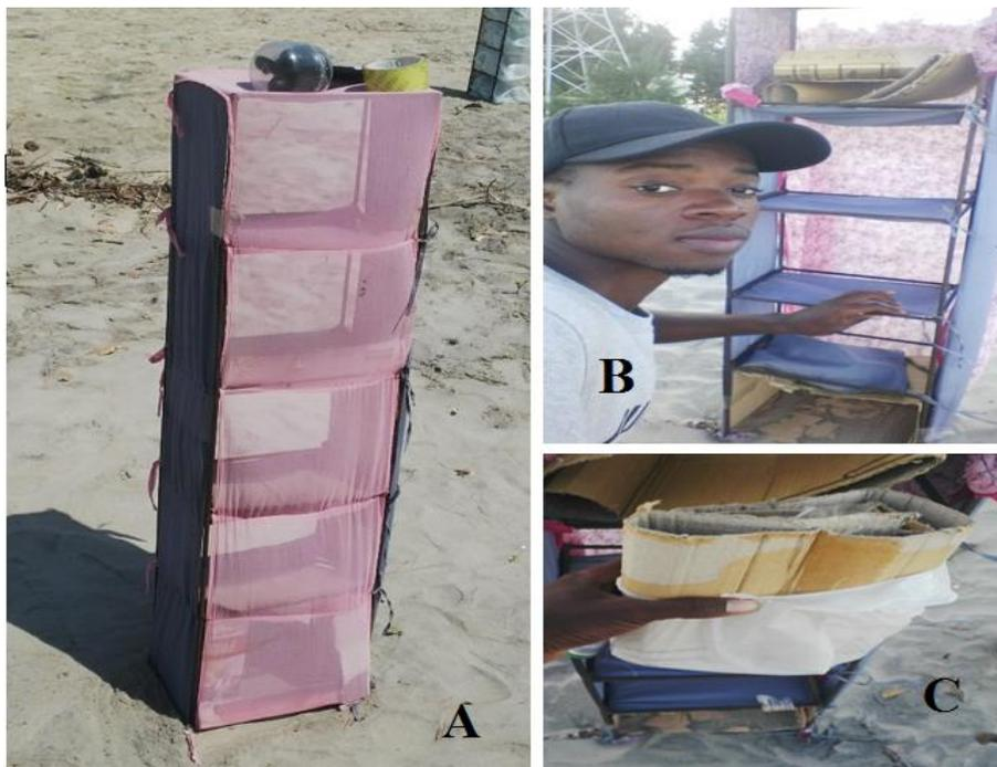
**Figura 18:** A) parte traseira da armadilha constituída por pano, B) Retirada dos sedimentos para posterior pesagem e C) armazenamento dos sedimentos no plástico a pois a colheita.
