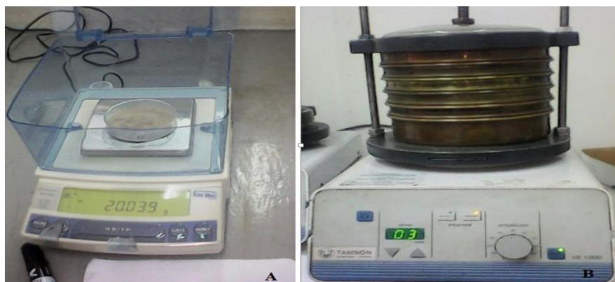
**Figura 20:** A) Pesagem dos sedimentos com a balança electrónica e B) Vibrador agitando os sedimentos existentes na peneira.
