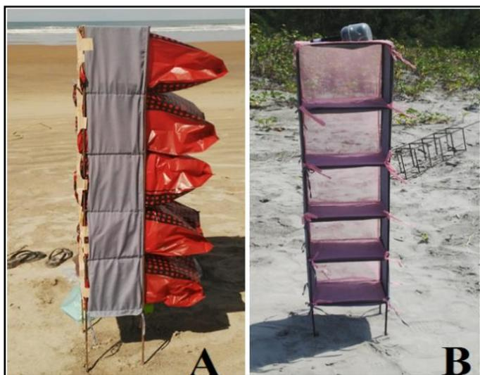
**Figura 16:** A) Armadilha constituída pelo plástico na parte traseira (armadilha de plástica); B) Armadilha constituída por pano na parte traseira (armadilha de pano).
