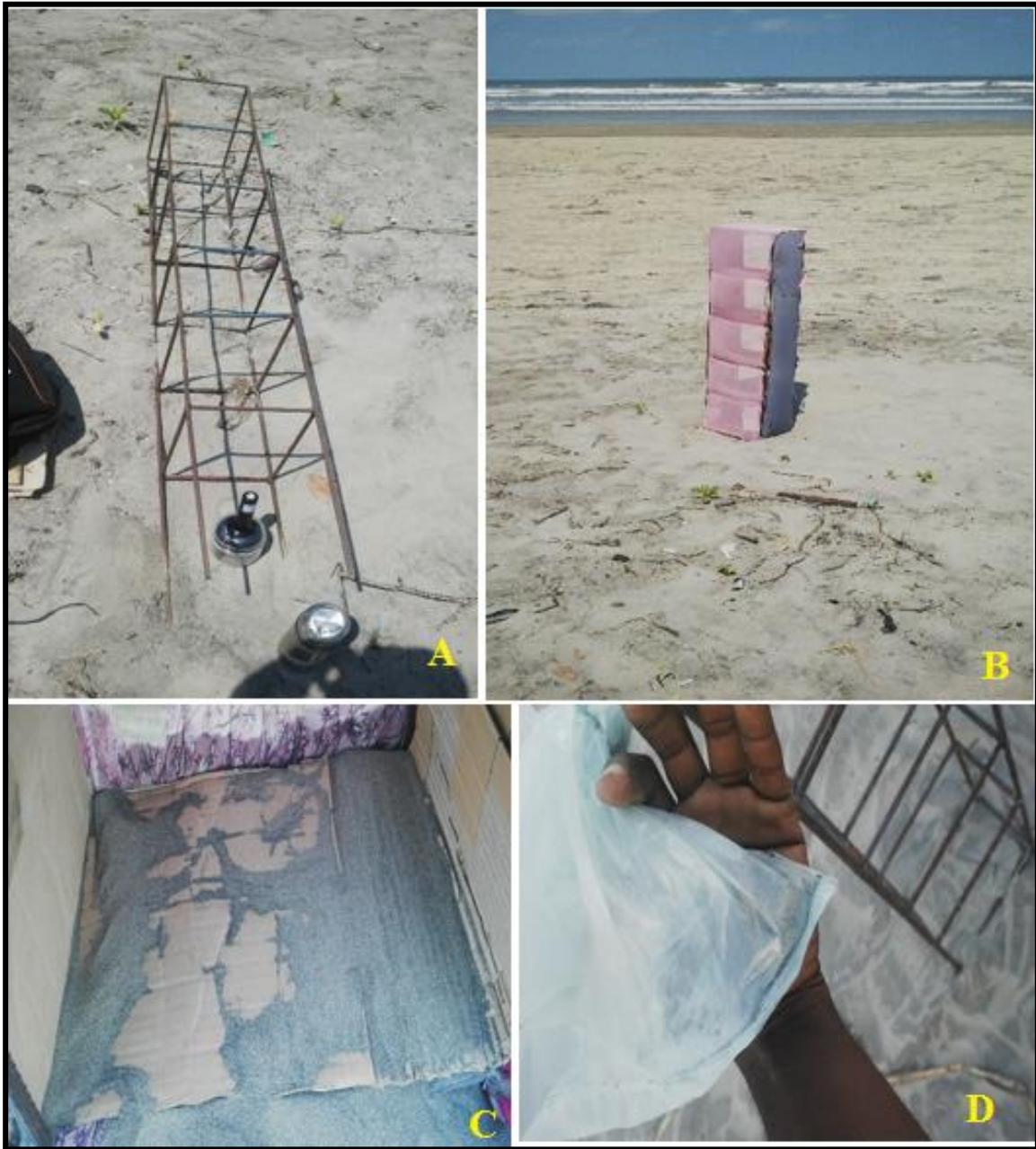
**Figura 21:** A) Estrutura da armadilha, B) Armadilha de pano fixada para a colecta, C) Sedimentos captados na 1ª subdivisão da armadilha e D) Saco plástico contendo sedimentos armazenados para a posterior análise.
