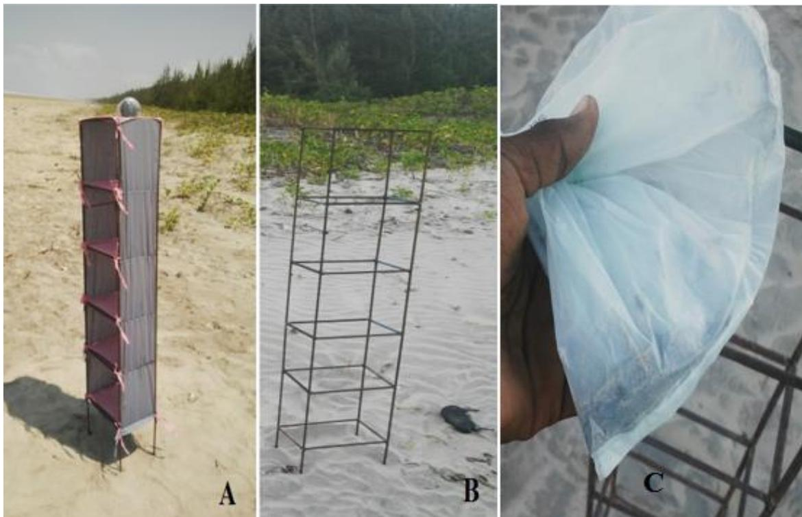
**Figura 12:** A) Armadilha eólica de sedimentos pronta, B) Estrutura da armadilha e C) Saco plástico com sedimentos captados.
