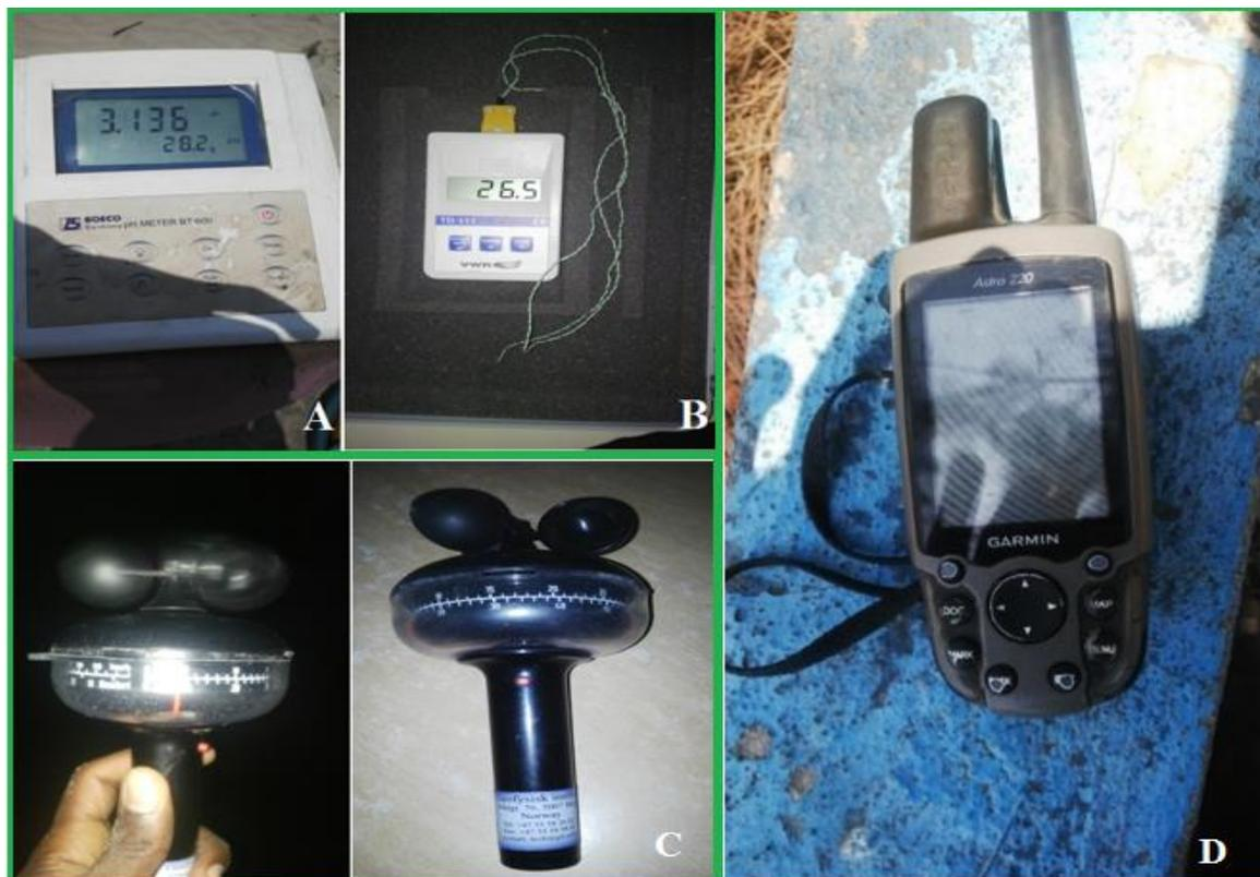
**Figura 13:** A e B) termómetro, C) Anemómetro de copos ou conchas e D) GPS
