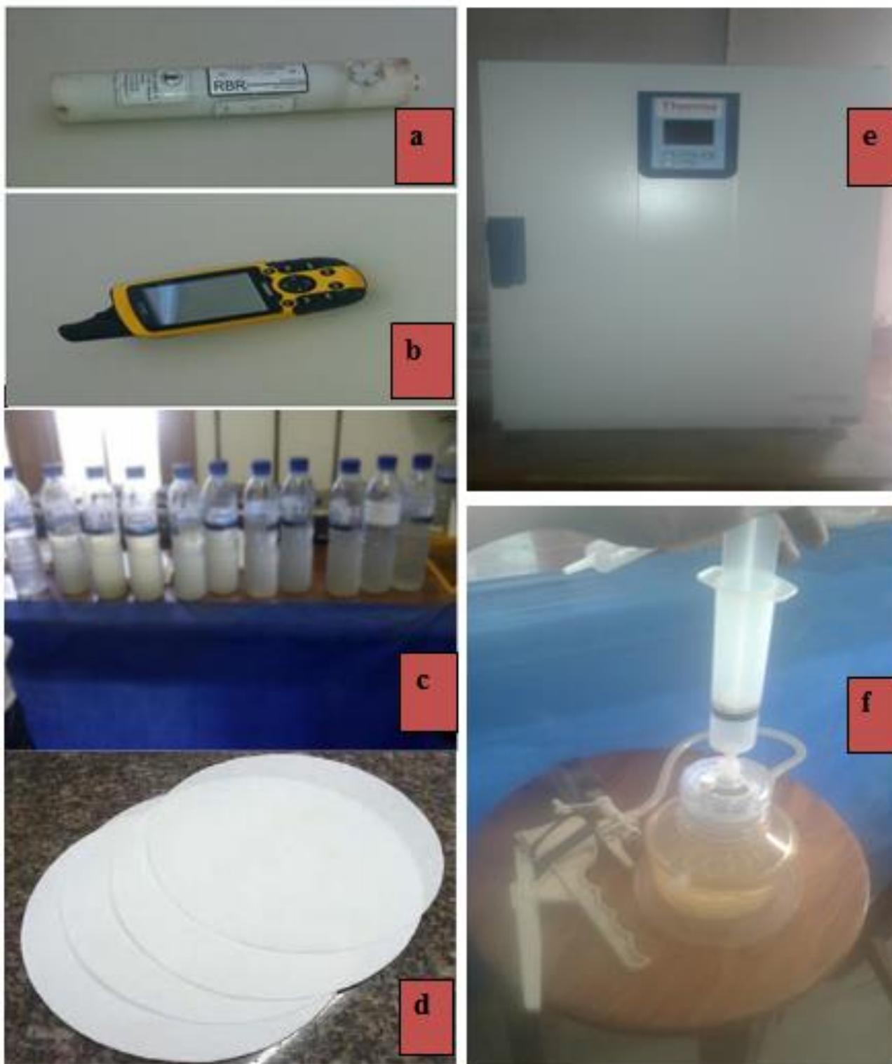
**Figura 6.** Equipamentos usados: a) Marégrafo, b) GPs, c) Garrafas plasticas de 0.5L, d) Papeis de filtro de 0.45  $\mu\text{m}$  e) Estufa e f) Filtro whatman. Fonte: autor
