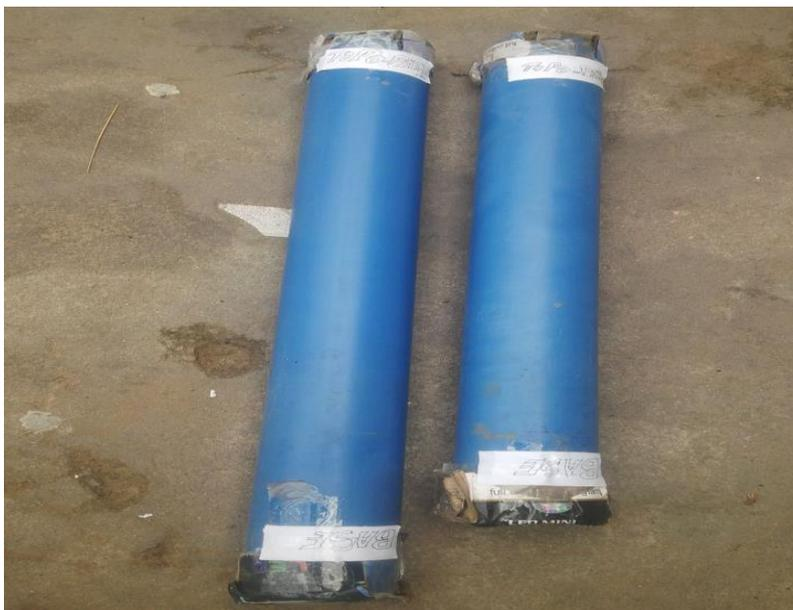
**Figura 3:** Testemunhos devidamente preparados para o transporte: embalados e identificados na extremidade de topo e base. (Acervo fotográfico do autor)
