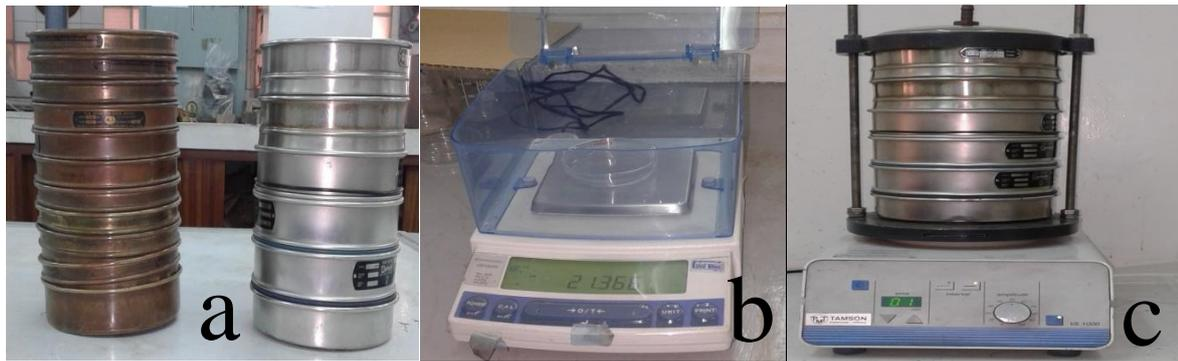
Figura 6: a) Peneiras granulométricas; b) Balança digital; c) Vibrador
