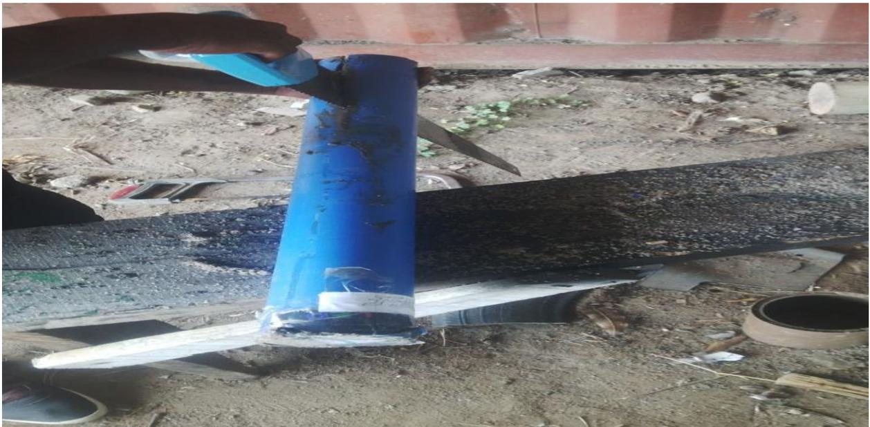
**Figura 4:** O corte longitudinal de testemunhos
