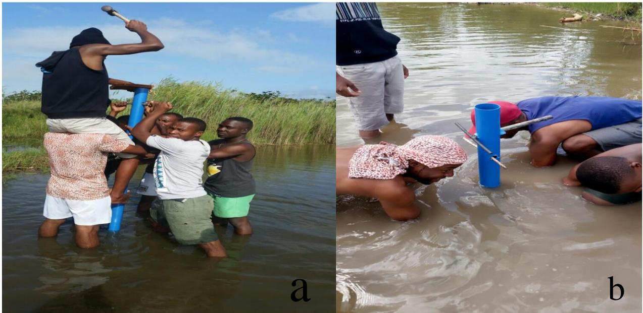
**Figura 2:** a) Momento de propulsão dos testemunhos; b) Momento de retirada dos testemunhos.
