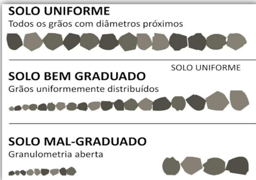
**Figura 3:** Classificação do solo quanto à distribuição dos grãos (Souza e Bastos, 2015).
