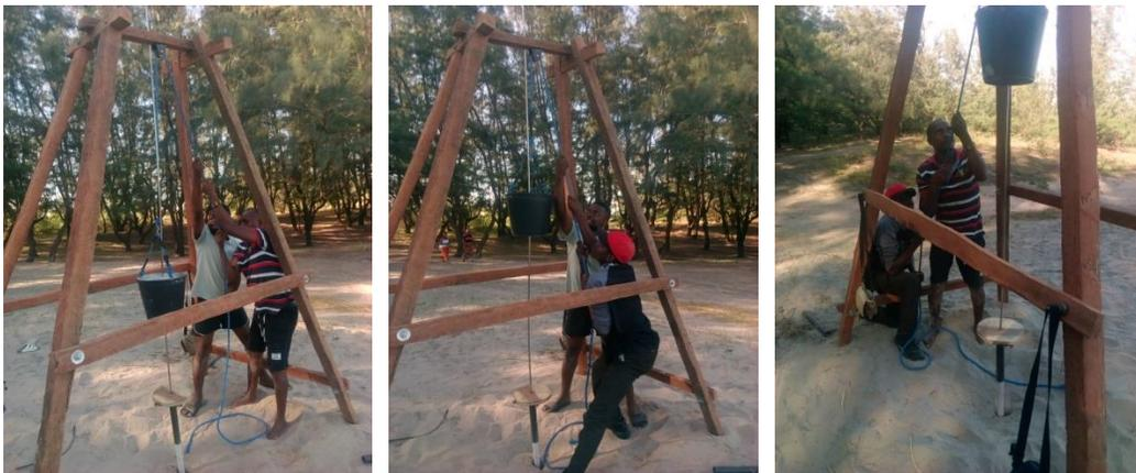
**Figura 10:** determinação do índice de resistência a penetração do solo.
