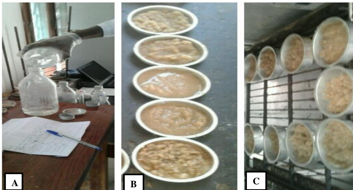
Figura 8: Ilustração de remoção da matéria orgânica. A: Redução da percentagem do peróxido de hidrogénio, B: Processo de Mistura de peróxido de hidrogénio e Água destilada e C: secagem na estufa.
