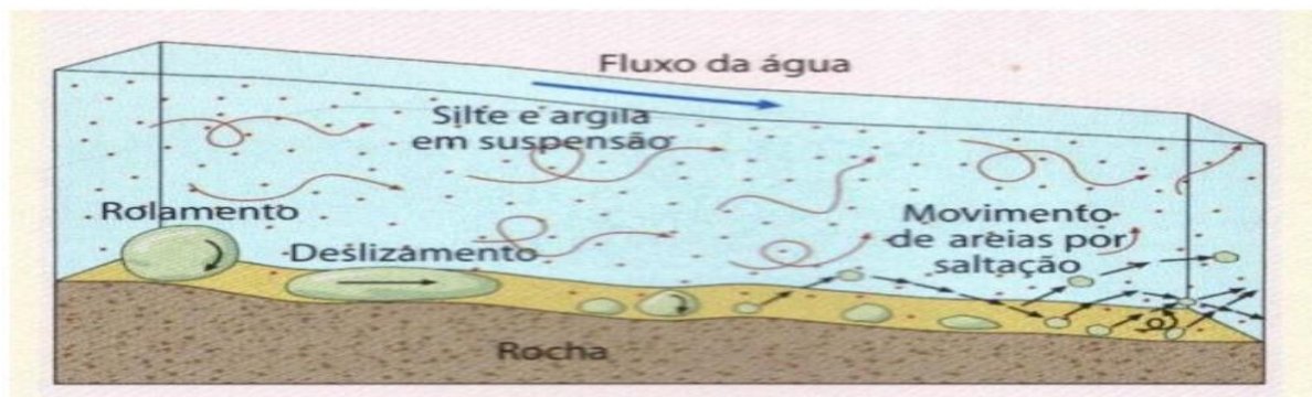
Figura 2: Mecanismo de transporte de sedimentos, Fonte Delgado (2011)
