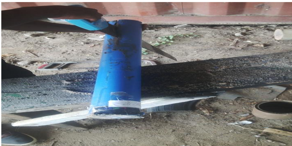
Figura 3: O corte longitudinal de testemunho (PVC)
