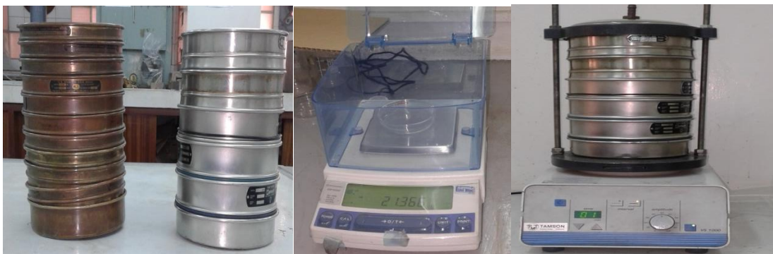
Figura 5: I) Peneiras granulométricas; II) Balança digital; III) Vibrador
