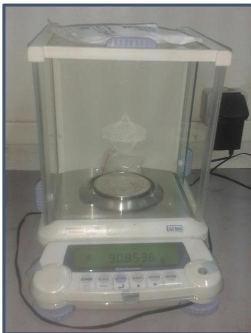
**Figura 3:** Balança XS-210 com precisão de 0,001 gramas, usada para a pesagem das amostras.
