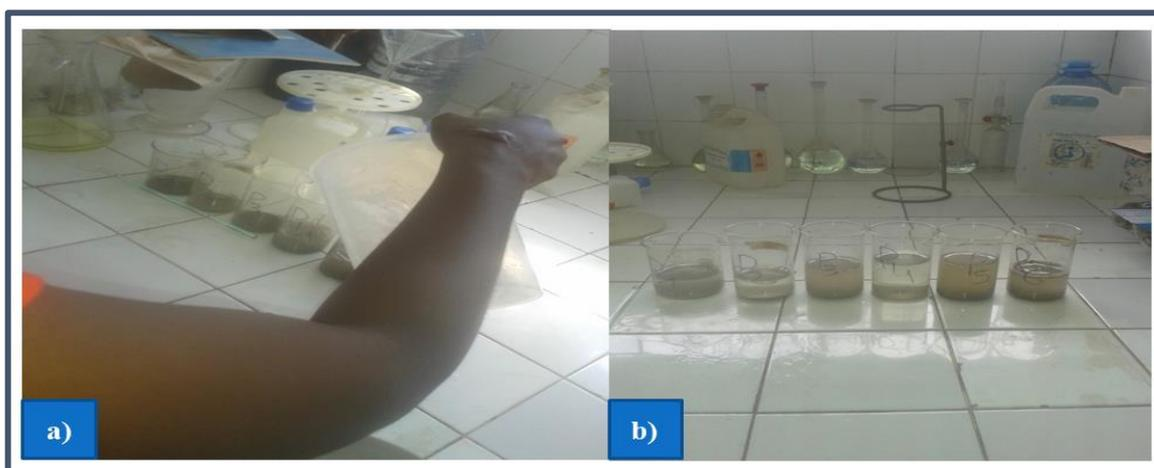
**Figura 4:** (a) Preparação do ácido clorídrico (HCl), peróxido de Hidrogénio (H<sub>2</sub>O<sub>2</sub>) mais água destilada para o ataque das amostras, (b) amostras em repouso após o ataque.
