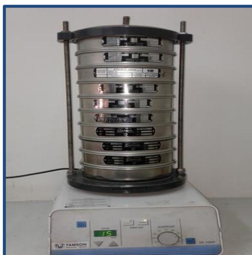
**Figura 5:** Crivos milimétricos para separação dos sedimentos
