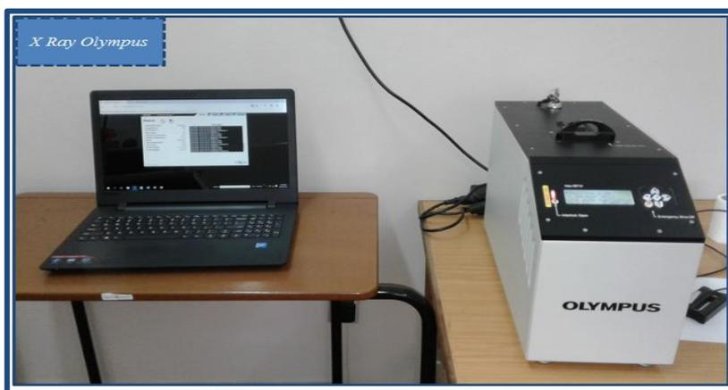
**Figura 6:** Difractómetro de raios-X marca Olympus, modelo BTXII instrumento usado para análise mineralógica dos sedimentos
