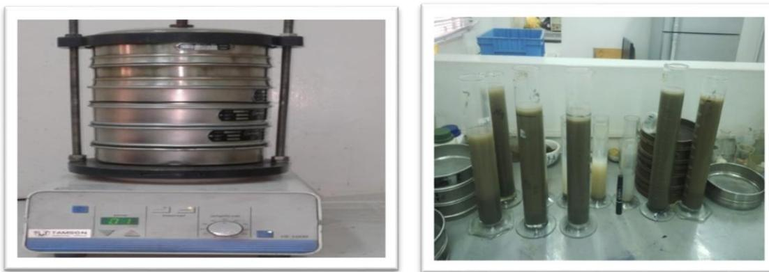
**Figura 5:** Peneiras granulométricas, usadas para peneiramento das amostras e colecta das fracções granulométricas dos sedimentos pelíticos (silte e argila).
