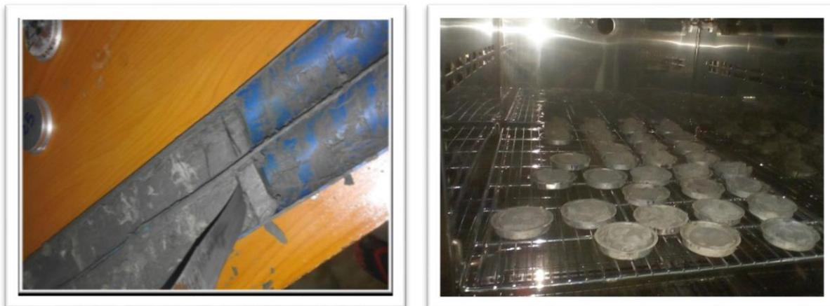
**Figura 3:** Corte dos tubos de PVC e Amostras de sedimentos prontas para o confeccionamento em sacos plásticos.
