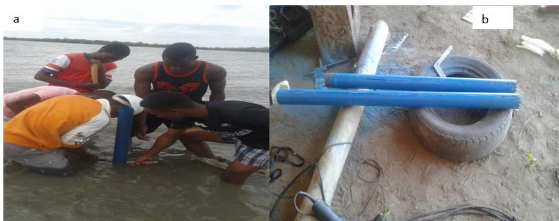
Figura 6: Imagem a) ilustra a retirada do testemunho e b) o processo de divisão em duas secções.
