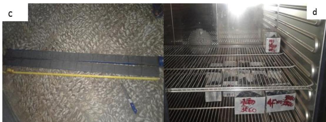
Figura 7: A primeira imagem c) mostra o testemunho já dividido em duas partes e a segunda d) tem-se as amostras a serem secadas na estufa.
