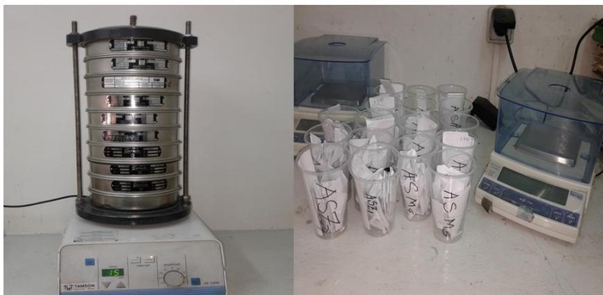
**Figure 6:** Crivo em escala milimétrica, vibrador e balança semi analítica utilizada para a separação e a pesagem dos sedimentos.
