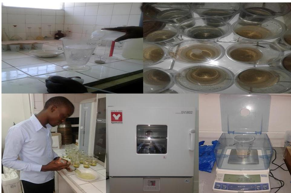
**Figura 5:** Material usado para eliminação dos carbonatos e matéria orgânica, secagem e pesagem dos sedimentos.
