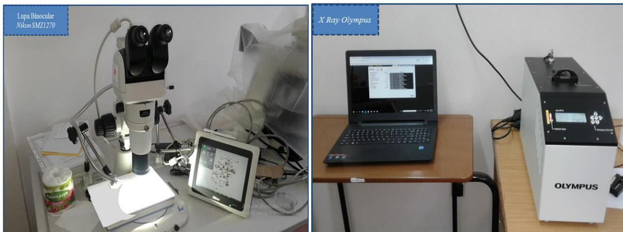
**Figure 8:** Lupa binocular *Nikon SMZ1270* e *X Ray Olympus* utilizados para identificação dos minerais.
