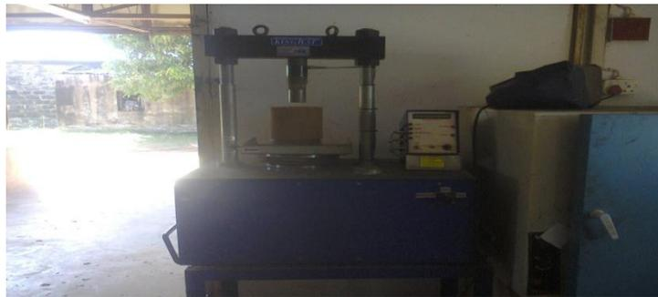
**Figura nº16: Prensa usada no laboratório para ensaios de CBR e PROCTOR**
