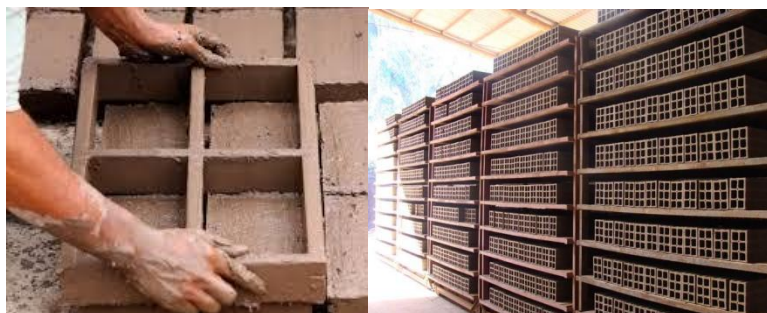
Figura nº 1: Produção Industrial de Blocos Cerâmicos
