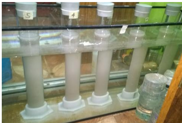
Figura nº 23: Tanque de Sedimentação contendo Cilindro com Solução e Água Aquecida a 32,8 ° C com Auxílio de um Termostato e Termómetro
