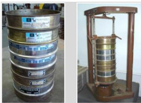
Figura nº 8: Série de Peneiras Padronizadas e Vibrador para o Ensaio de Granulometria por Peneiramento
