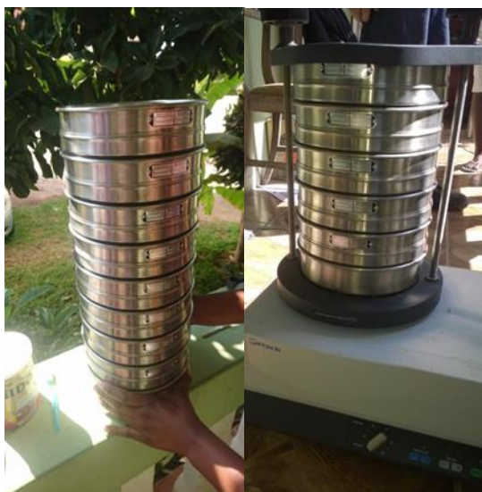
Figura nº 21: Análise Granulométrica por Peneiramento com Série de Peneiras Padronizadas e Vibrador Eléctrico Devidamente Ajustado
