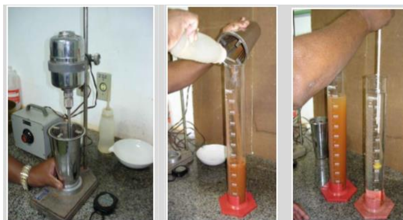
Figura nº 9: Agitador, Cilindros e Decímetro para o Ensaio de Granulometria por Sedimentação
