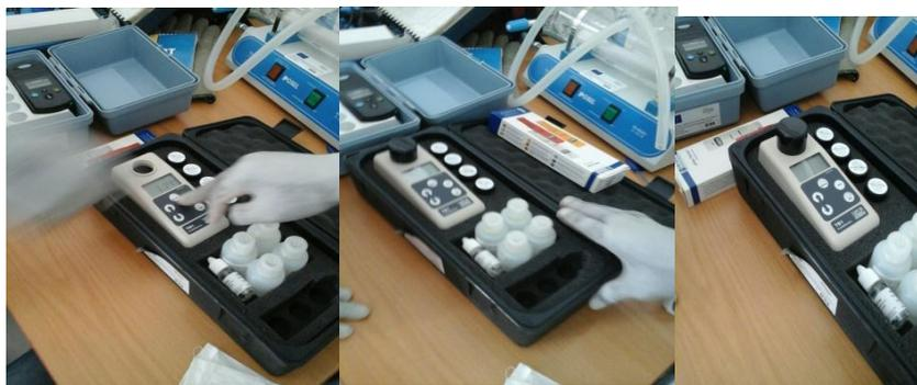
**Figura 9: Turbidímetro**
