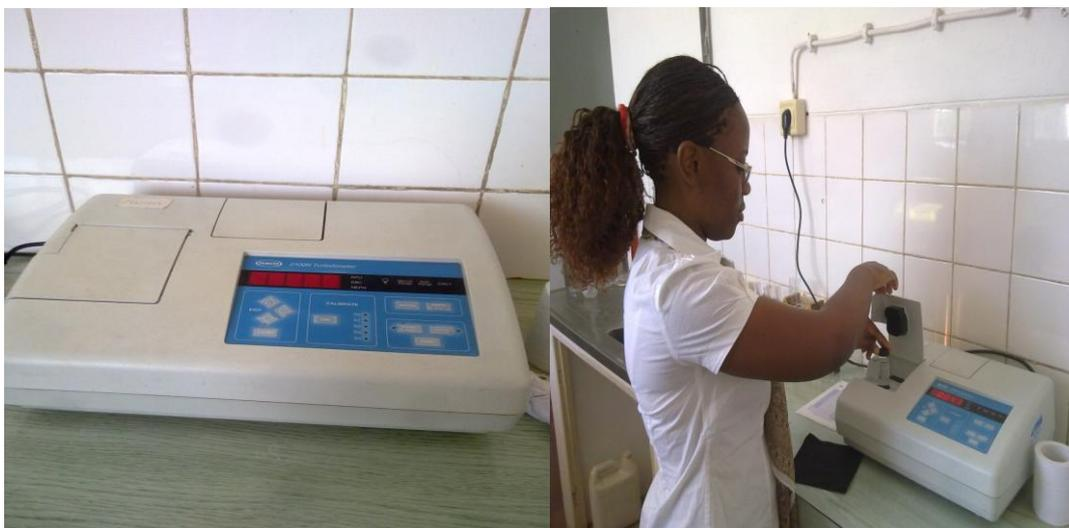
**Figura 1.** Turbidímetro
