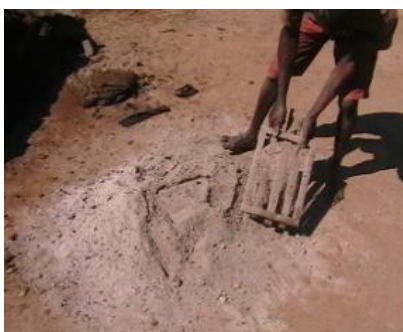
Fig: Colocação de cinza para desfazer a paga do barro na prensa manual
