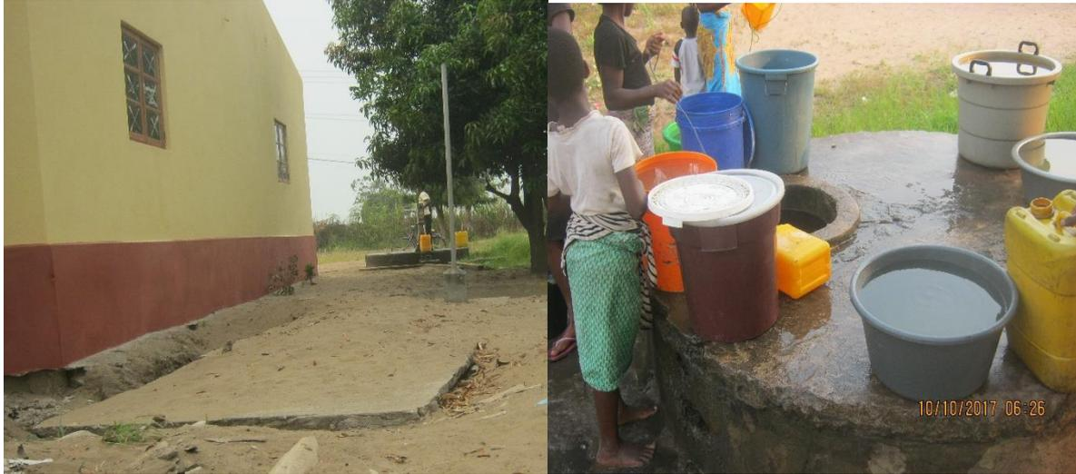
**Fotografia 1.** Poço instalado junto de uma fossa a (esquerda) e poço sem tampa com diferente baldes-cordas a (direita).
