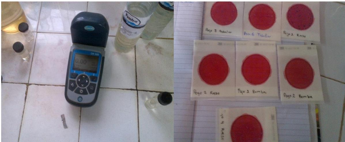
**Fotografia 2.** Colorímetro portátil a (esquerda) e placa de Petrifilm ilustrando pontos vermelhos de coliformes totais e pontos azul-escuro de *E. coli*.
