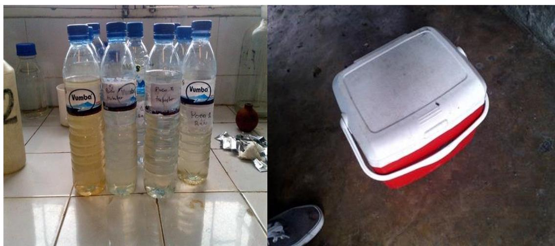
**Figura 8.** Garrafas de polietileno contendo água amostrada a (esquerda) e caixa térmica contendo gelo para conservação das amostras a (direita).
