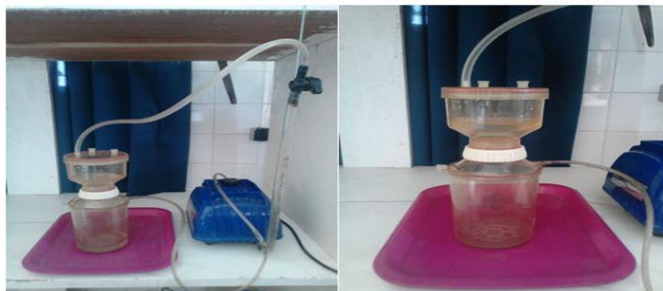
Figura 10: Sistema de filtração da água
