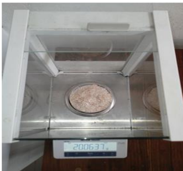
A) Pesagem de material triturado.
