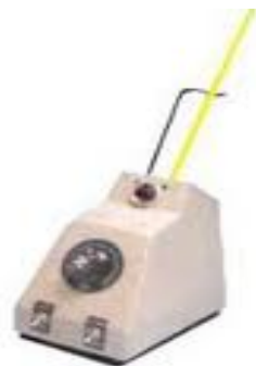
Fig. 4. Aparelho para a determinação do ponto de fusão equipado de um termómetro de mercúrio
