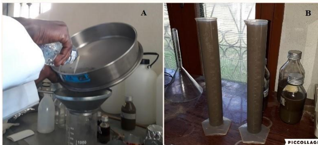
Figura 10. A – Separação da fracção areia (ISHCT). B – Sedimentação da fracção silte (ESCMC).
