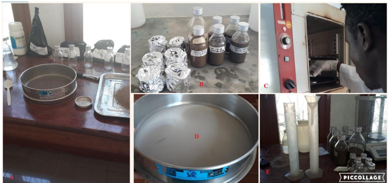
Figura 9. A – Peneiração de amostra 2mm (ESCMC). B – Solução de amostra silte e argila (ISHCT). C/E – Secagem da solução argila (ESCMC). D – Peneira 0,053mm (ISHCT). Fonte: Autor
