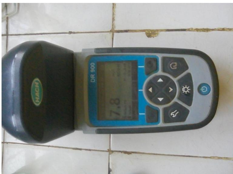
**Figura 3** :Ilustração do fotómetro usado para as análises
