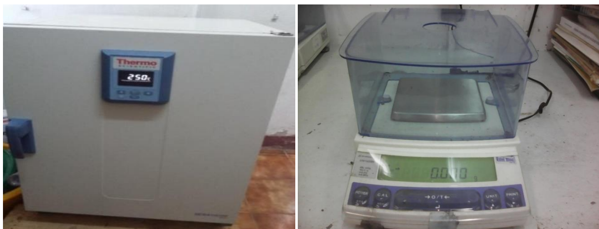
Figura 4: Estufa de marca THERMO 250C, usada para secagem das amostras a esquerda. Balança XS-210 com precisão de 0,001g a direita, usada para a pesagem das amostras.
