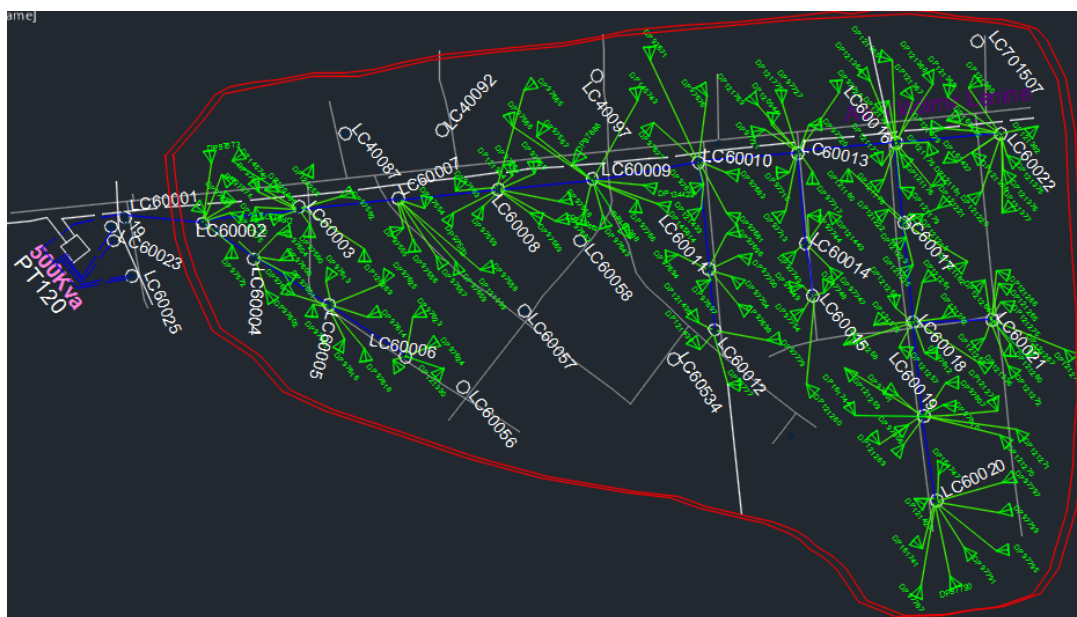
Figura 13: Mapa de número de consumidores identificados para a transferência da carga do PT120 para PT Novo. (Fonte: Manual da EDM Julho 2006)
