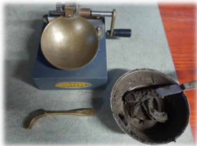
Foto 13: Mistura solo-água durante a realização do ensaio de limite de liquidez.
