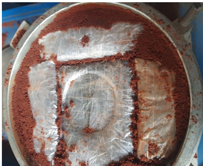
Foto 19: Superfície do molde após o ensaio CBR adaptado. Fonte: Autor
