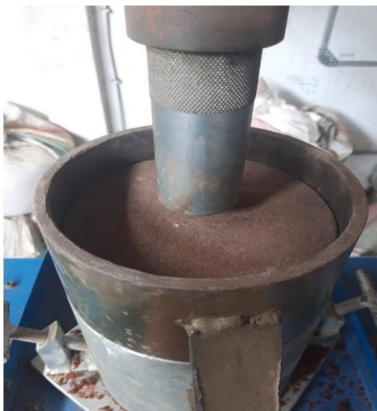
Foto 18: Activação do pistão sobre o maciço do molde que foi colocado sobre o material contido no molde. Fonte: Autor
