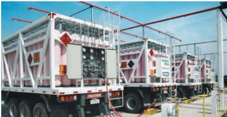
Figura 17. Estação de descompressão de GN (fonte: White Martins)
