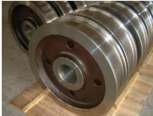
Figura 5 - Roda com aba para ponte rolante [ Fonte Modelagem paramétrica de pórticos rolantes,2005 ]
