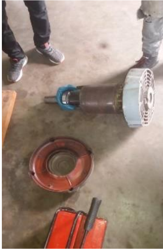
Fotografia 3: Rotor do motor eléctrico e tampas do mesmo.
