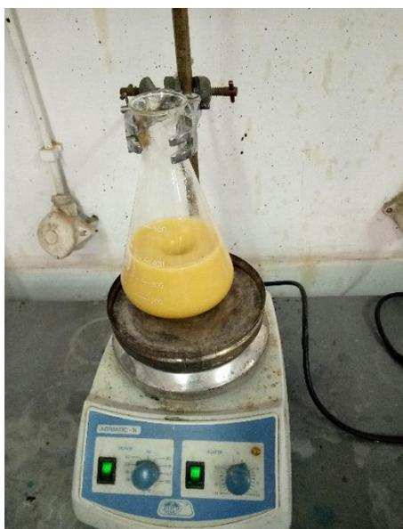
**Figura 12:** Activação da bentonite amarela com carbonato de sódio.
