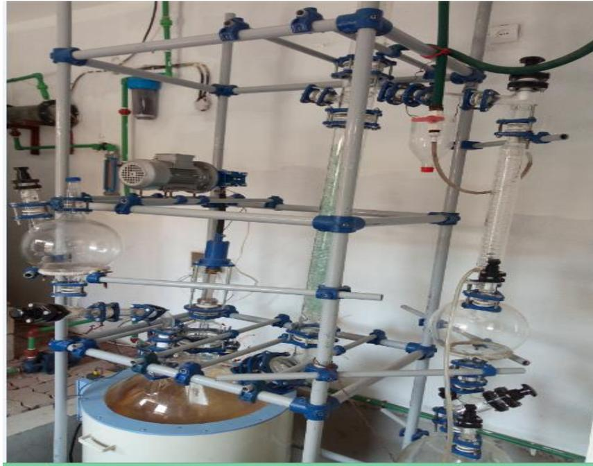
*Figura A3.1-Coluna de destilação fracionada.*
