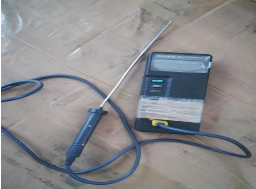
**Figura A3.4-**Termómetro digital usado para medição da temperatura.
