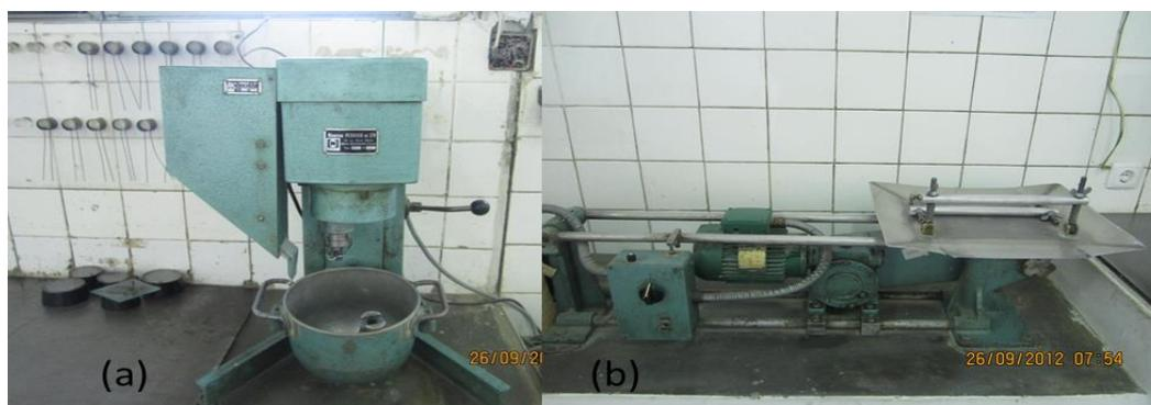
**Figura 5:** Misturador mecânico (a) e compactador mecânico (b) usado para preparação da argamassa
