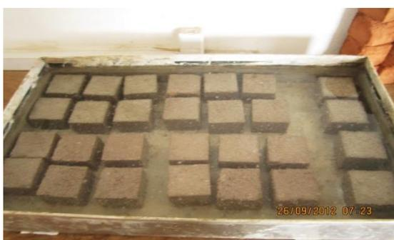
**Figura 9:** Provetes cúbicos em cura
