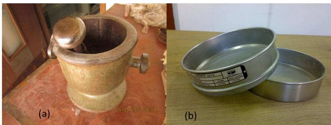
**Figura 4:** Triturador manual (a) e peneira de 75 $\mu$ m (b)
