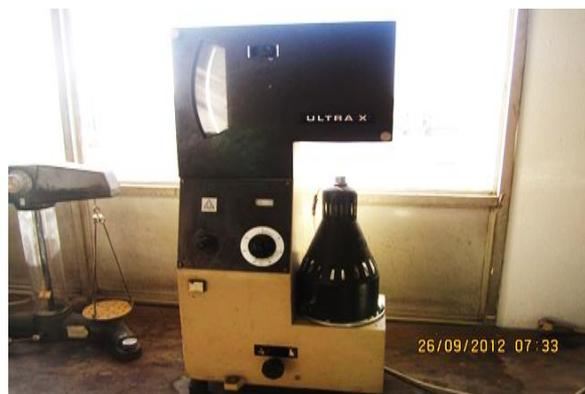
**Figura 8:** Aparelho Ultrax usado na determinação da quantidade de água necessária a ser adicionada à argamassa
