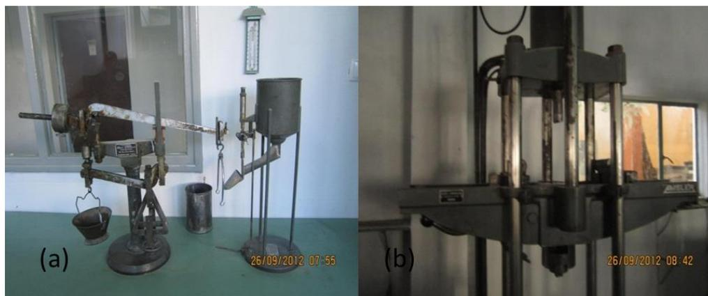
**Figura 7:** Prensas usadas para ensaios à flexão (a) e compressão (b) dos corpos de prova prismáticos
