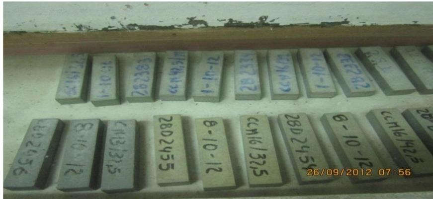
**Figura 6:** Corpos de prova prismáticos na sala de cura
