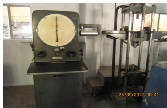
**Figura 10:** Prensa para determinação de resistência à compressão de blocos
