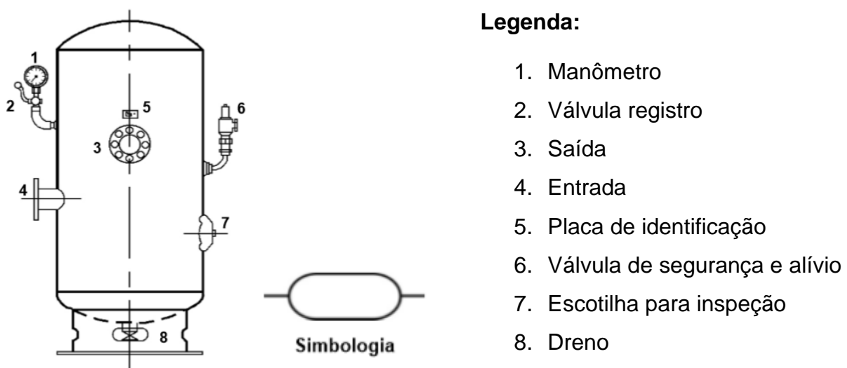
Figura 32: Reservatório de AC
