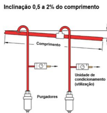
Figura 23: Instalação da linha de alimentação.
