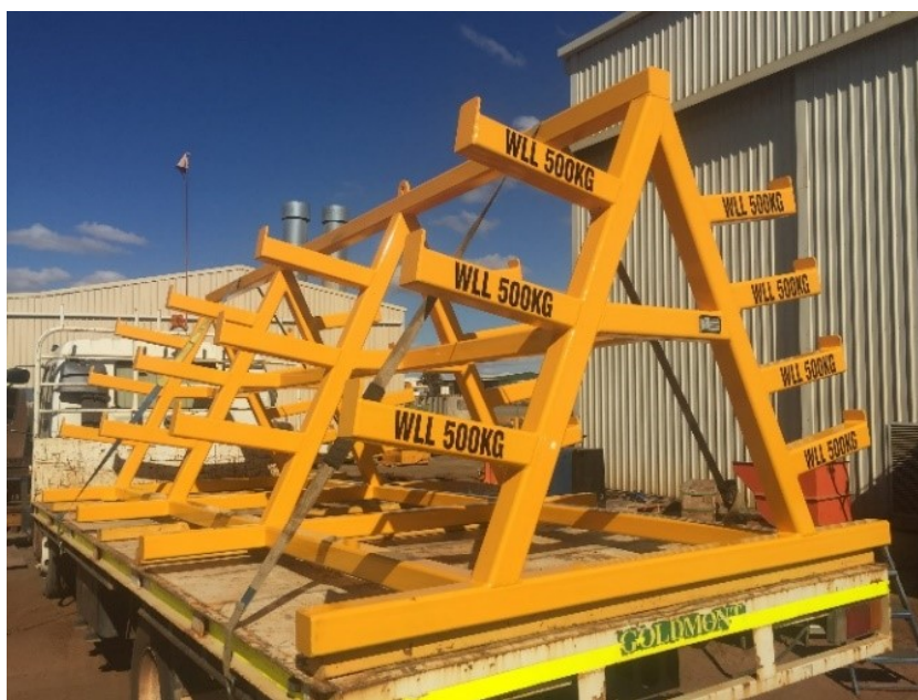
Figura 2-1- Rack metálico para armazenamento de haste de perfuração
