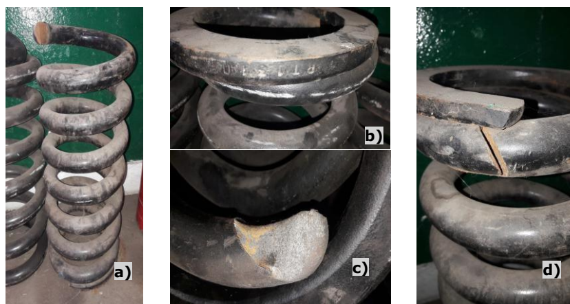
Figura 4: Ilustração das quebras mais frequentes de molas de diversas locomotivas em circulação nos CFM- Sul.
