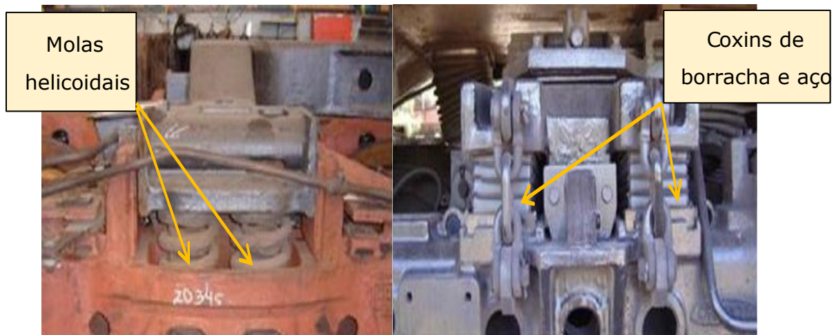
Figura 10: Molas helicoidais e coxins de borracha e aço.
