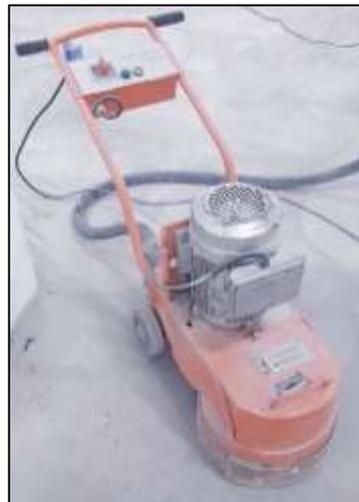
**Figura 46:** Lixadeira mecânica.
