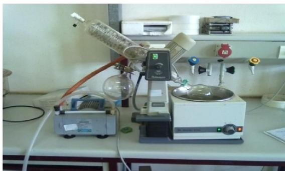
**Figura 20.** Separação de óleo e solvente através do rota vapor
