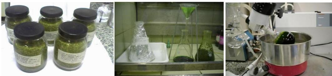
a) Folhas trituradas      b) Maceração e filtração      c) Evaporação do solvente
