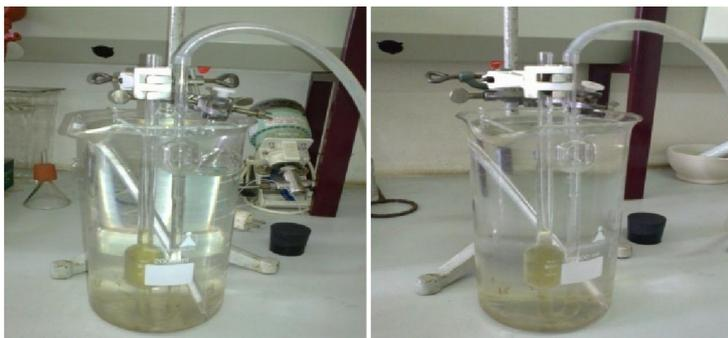
**Figura 22.** Esquema de determinação de viscosidade com o viscosímetro de Ostwald
