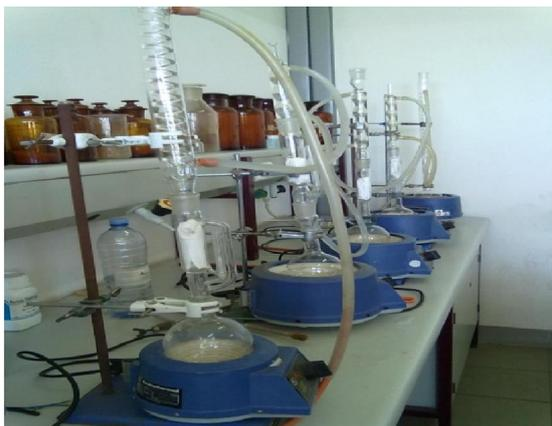
**Figura 19.** Esquema de aparelhos Soxhlet
