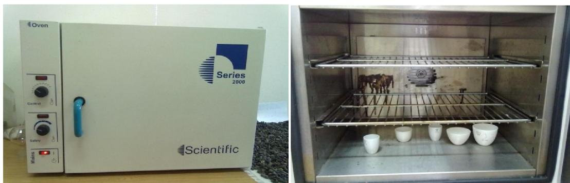
**Figura 18.** Estufa usada na determinação da humidade das sementes e do óleo de *Jatropha curcas* L.
