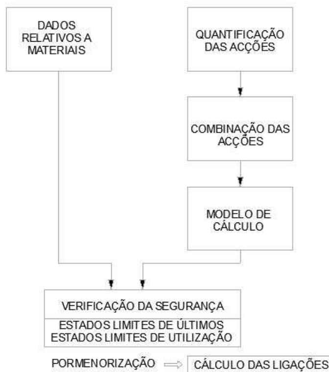
Figura 6: Fluxograma de metodologia de cálculo de estruturas de madeira
