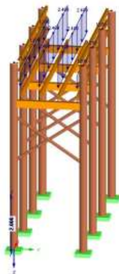
Figura 7: Distribuição das cargas sobre as vigas longitudinais
