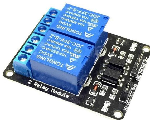
Figura 14: Modulo rele de 2 canais
