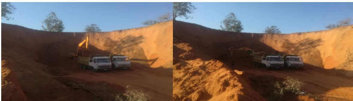
Figura: 4.2: Pá escavadora a abastecer os camiões no interior da cova com areia vermelha.
