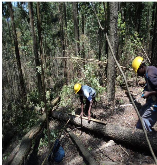
Figura 4: Sêquencia de actividades da colheita de dados para a cubicagem: (A) Selecção das árvores; (B) Derrube das árvores do; (C) e (D) Seccionamento e medição dos diâmetros da base até ao ápice do fuste.
