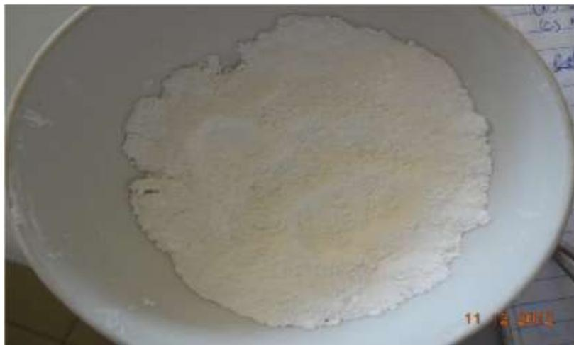
**Figura 3.2** –  $\text{CaO-Al}_2\text{O}_3$  sintetizado através do método de coprecipitação.
